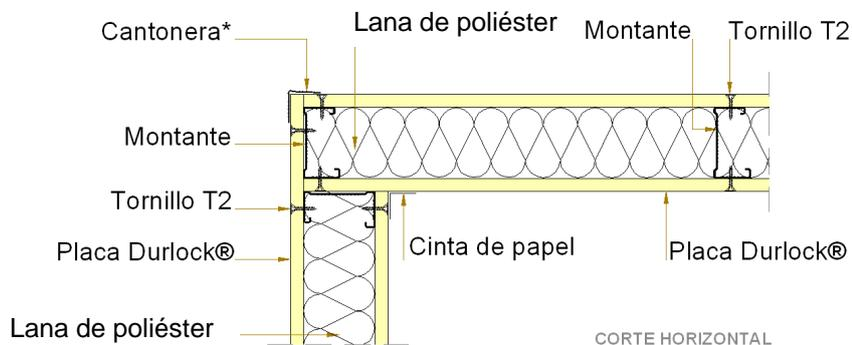
\* El perfil Cantonera podrá fijarse con tornillos T2 colocados con una separación de 15cm o con adhesivo de contacto. Luego recibirá dos manos de masilla Durlock®.
