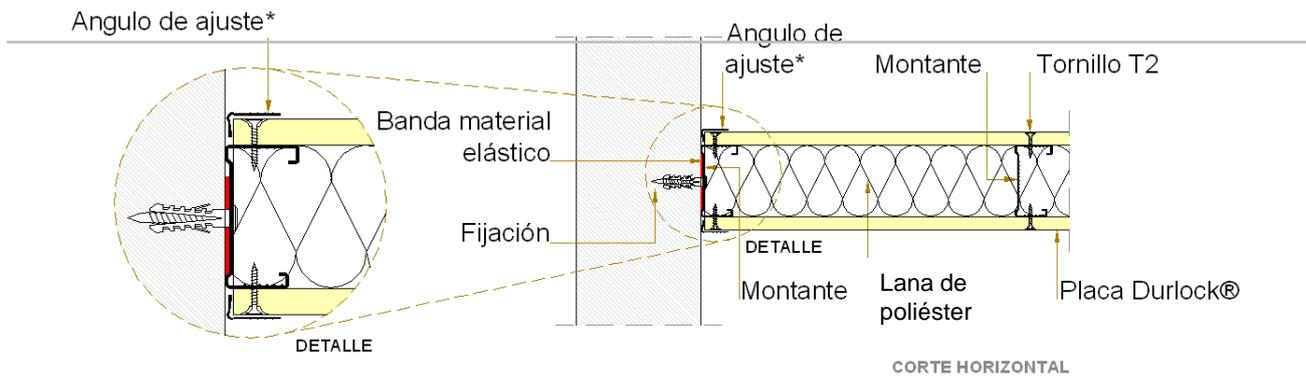
\* El perfil Angulo de ajuste podrá fijarse con tornillos T2 colocados con una separación de 15cm o con adhesivo de contacto. Luego recibirá dos manos de masilla Durlock®.
