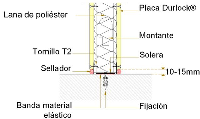
Fijación de solera inferior. Ambientes húmedos. Solución banda + sellador hidrófugo.
